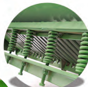
Sistema di setaccio con molla Screen system with spring
